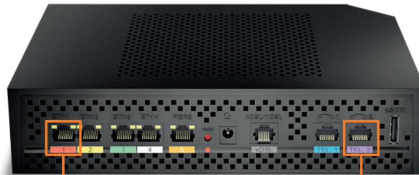
Un port Ethernet pour le fonctionnement de l'alarme.
